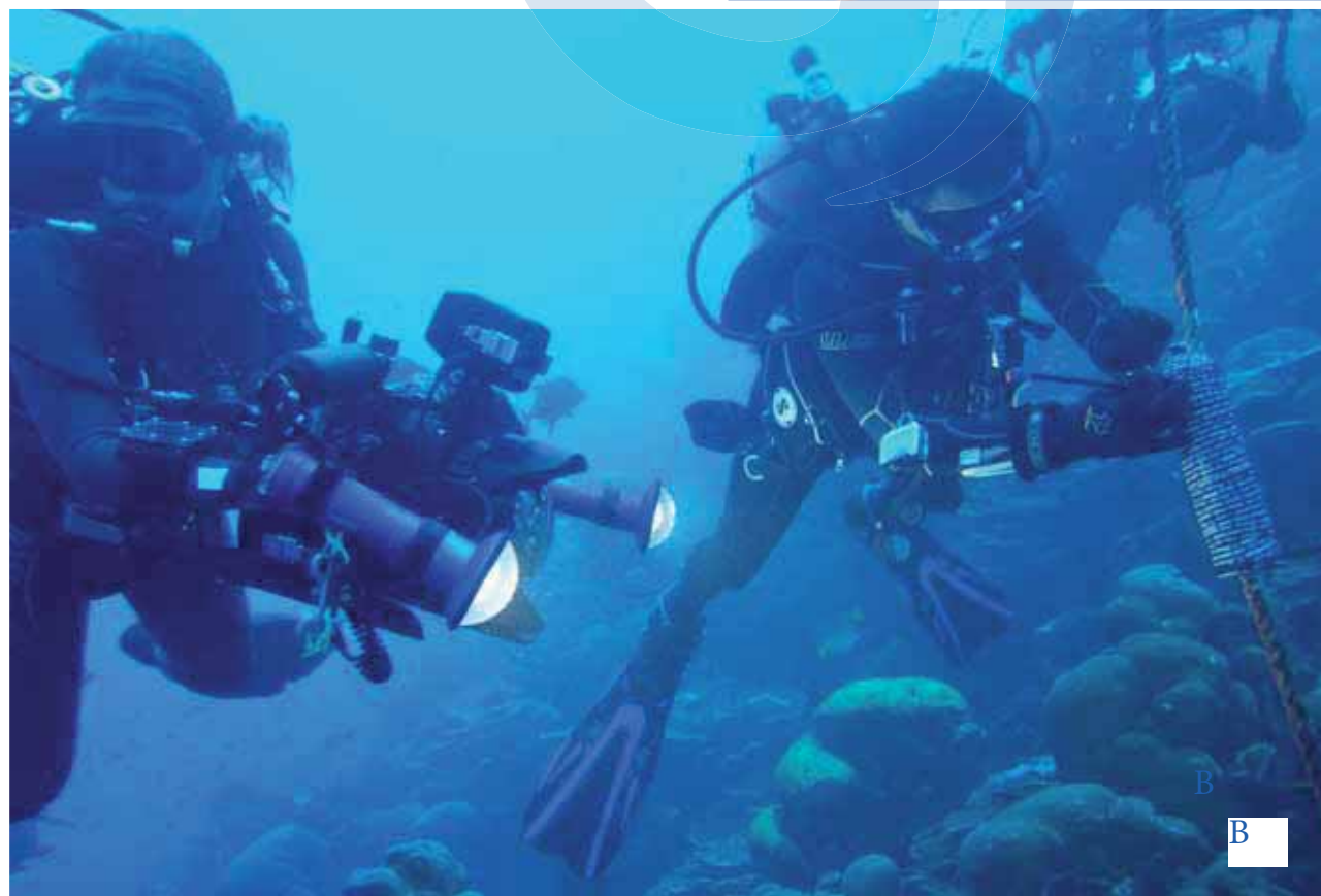
Figure 2-45. A: Aspect du VR2 de la côte Est, recouvert d'algues encroutantes. B: Mauricio Hoyos en train de remplacer un nouveau VR2 recouvert d'un film plastique de protection contre le fouling et les algues.
