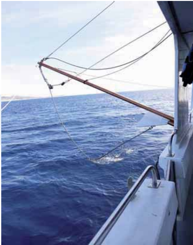
Figure 1-5. Tangon du Quino permettant l'immersion d'une module métallique (blanc) qui stabilise le bateau en limitant le roulage.
