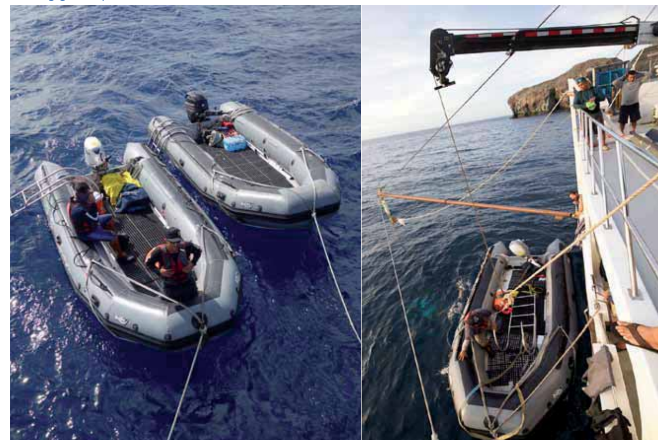
Figure 1-4. Annexes du Quino El Guardian qui sont des unités gonflables de 5,5 m, équipées de moteurs hors-bord de 60 CV. A noter que la fragilité relative d'une quille non rigide n'a pas permis le franchissement de la barre autour de l'atoll de Clipperton, obligeant les plongeurs à se mettre à l'eau pour débarquer et ré-embarker.
