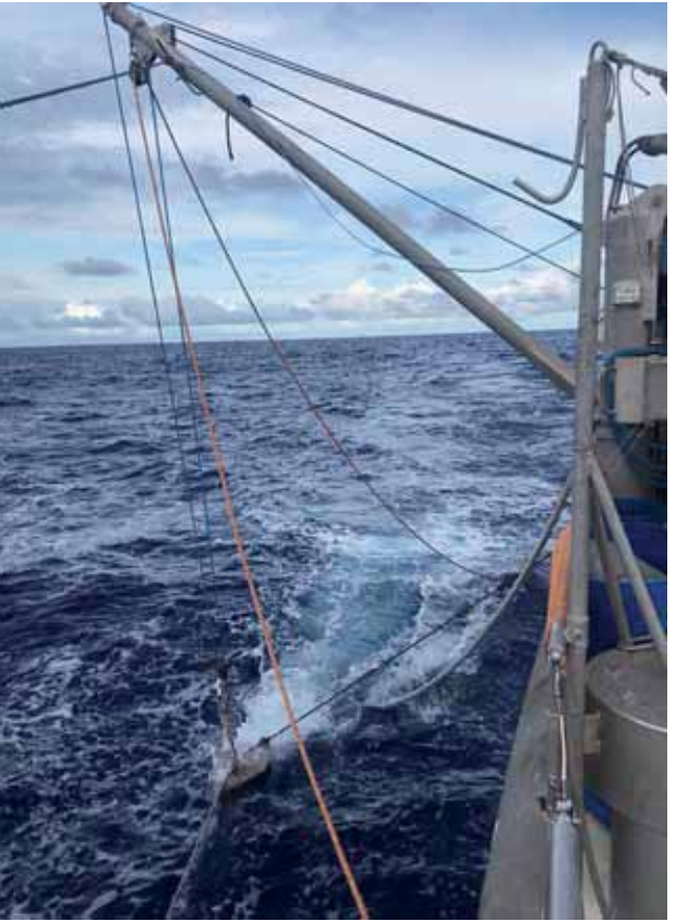
Figure 3-28. A gauche: vue sur le déploiement du 'dolphin' de jour sur tribord arrière. La carcasse inox munie d'une fente verticale antérieure est profilée et bardée d'un poids pour stabiliser le débit d'eau recueillie. A droite: cette eau est ensuite transférée sur le 'mur à tuyaux' où elle est destinée à divers traitements.
