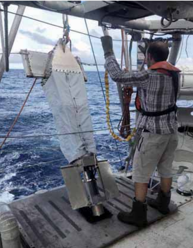
Figure 3-30. Vue du dispositif HSN (High Speed Net) avant son déploiement de jour à la poupe du voilier, pendant en moyenne 90 mn.
