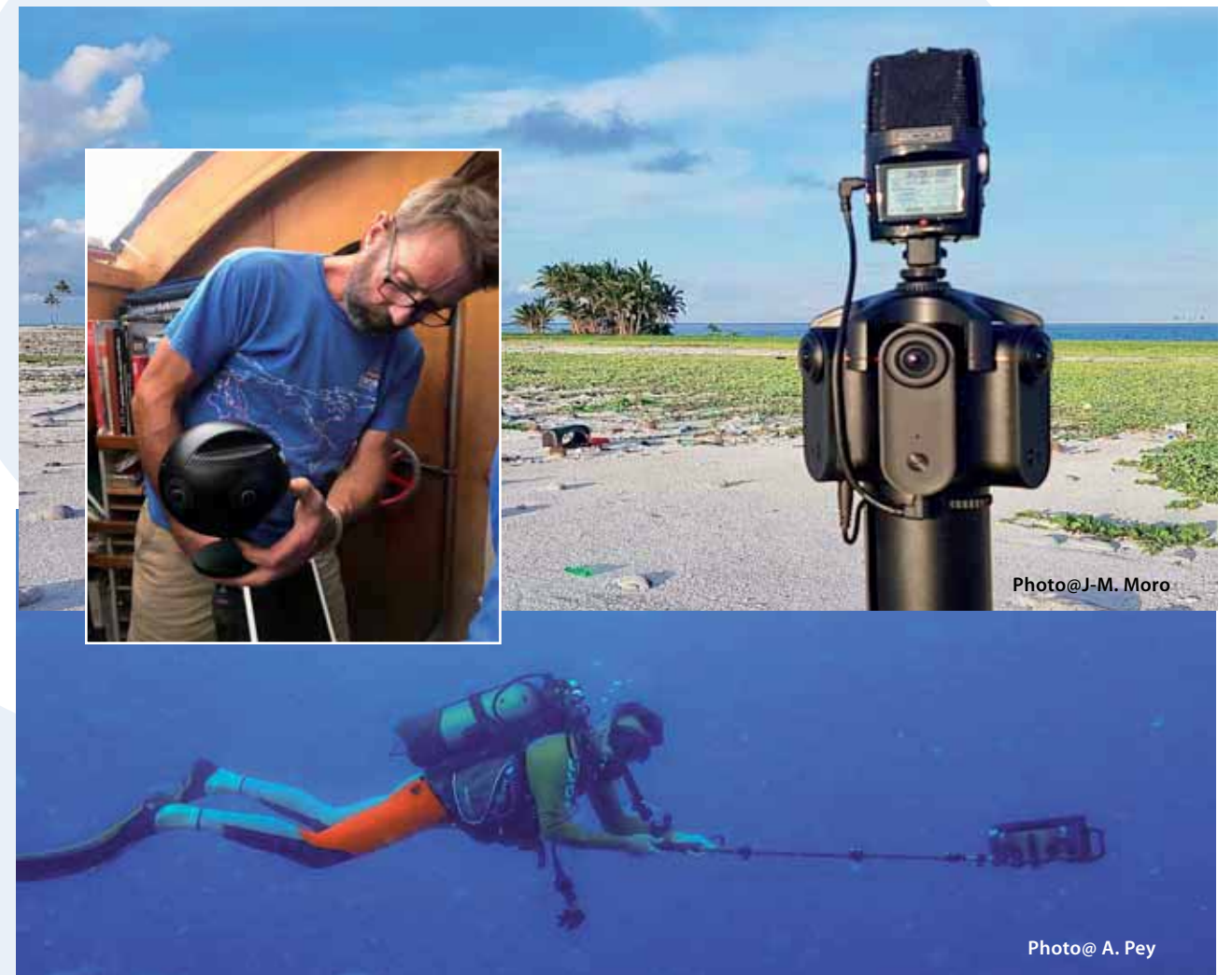
Figure 1-10. Le système innovant repose sur des rigs de captations constitués de multiples cameras et permettent de restituer une vision binoculaire des scènes filmées. Les treize cameras qui le constituent produisent, après post production, une image en 8K. L'utilisation peut être terrestre ou sous-marine avec un caisson Ad hoc qui capte à 360° dénommé BelugaVR.
