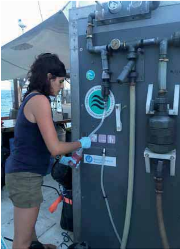
Figure 3-28. A gauche: vue sur le déploiement du 'dolphin' de jour sur tribord arrière. La carcasse inox munie d'une fente verticale antérieure est profilée et bardée d'un poids pour stabiliser le débit d'eau recueillie. A droite: cette eau est ensuite transférée sur le 'mur à tuyaux' où elle est destinée à divers traitements.
