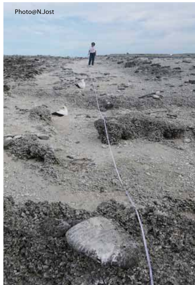
Figure 2-24. Vue au sol de la mesure au point M1 qui révèle la présence éparse des agrégats phosphato-calcaires durs qui ont été très érodés par les passages d'eau. Ces agrégats surplombant la plage côté océan étaient simplement interrompus dans la zone M1 en 2016 et 2018, et ils ont maintenant disparus sur plusieurs dizaines de mètres de largeur, signant des passages d'eau probablement massifs et récurrents.
