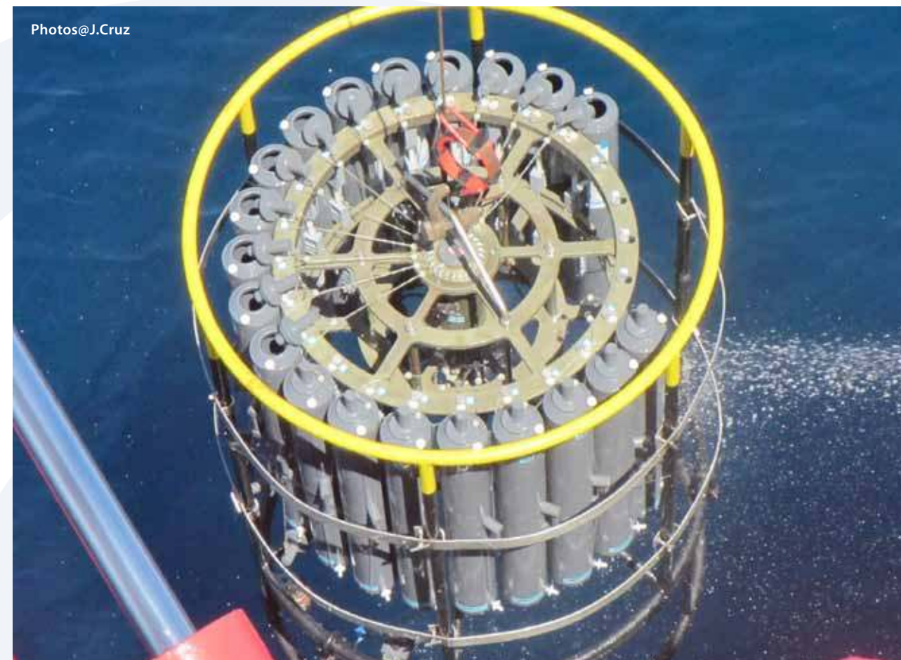
Figure 4-18. Rosette avec profileur de profondeur, température et conductivité, avec bouteilles Niskin de 12 litres pour échantillons d'eau.
