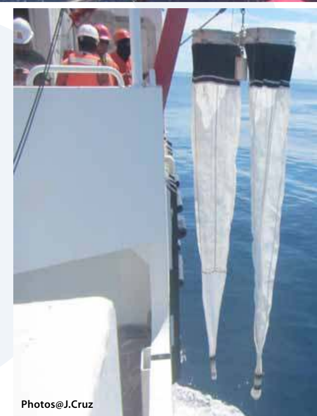
Figure 4-19. Filets à plancton immergés en parallèle de la CTD et ce, afin d'évaluer un niveau de production primaire.
