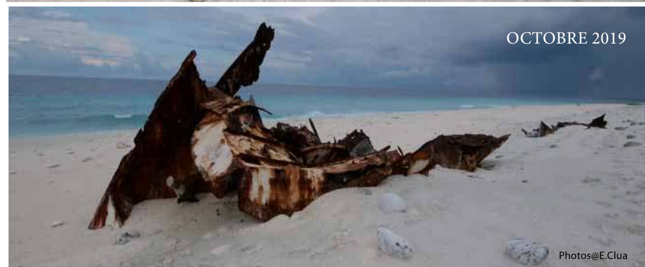
Figure 2-26. Vestiges de l'épave du Lily Mary à proximité du camp américain sur la façade Est (voir Fig 2-2) qui s'est échouée là en 2000. En haut aspect de l'épave en février 2016 et en bas, la même épave trois ans et demi après: le bas de la coque s'est affaissé et disloqué, la surface en tôle a diminué d'environ 20%.
