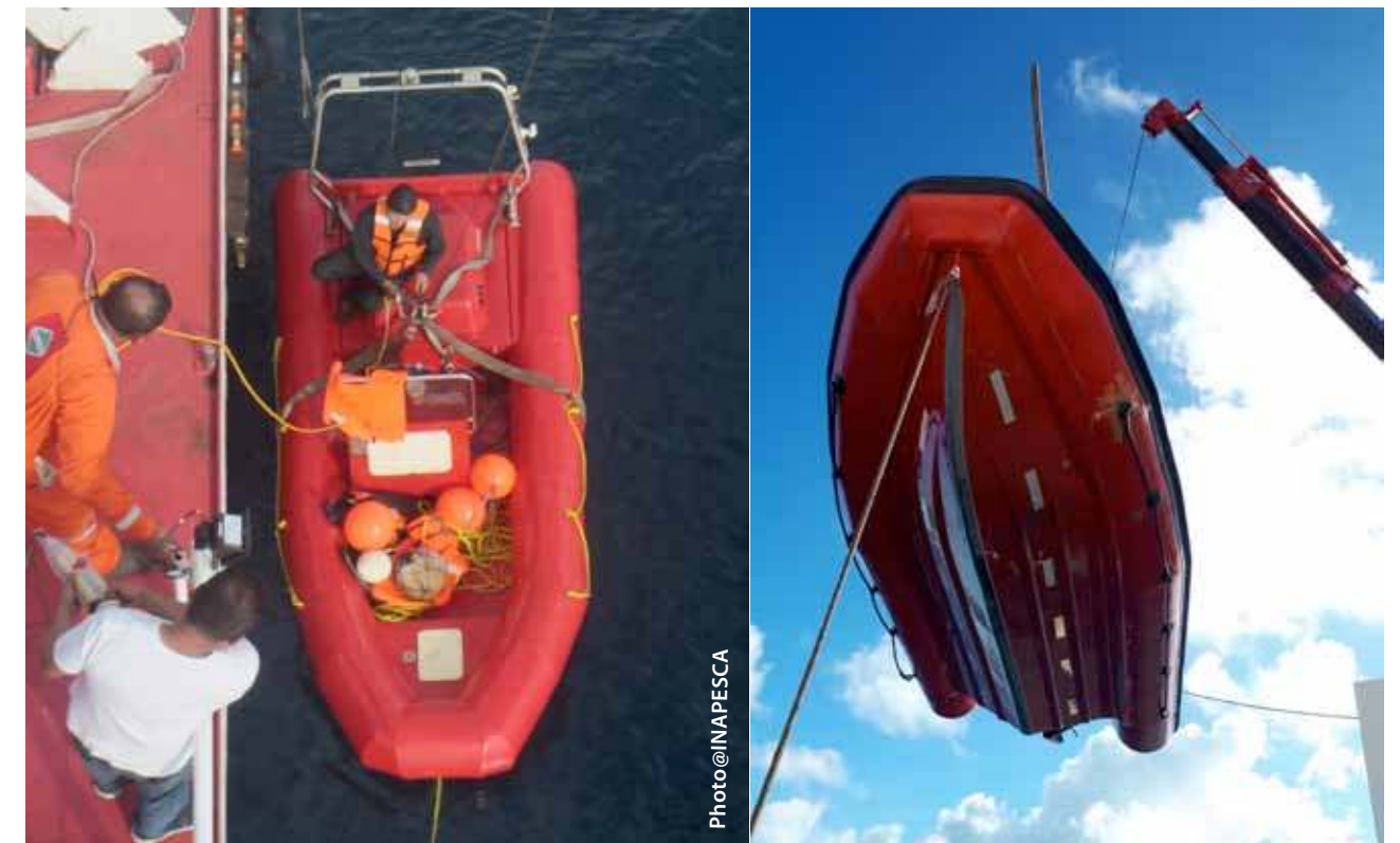
Figure 1-4. Gauche et droite : Vues de l'embarcation (mise à l'eau par grue et à couple du Carranza) équipée d'une turbine et d'une coque métallique, adaptées à des évolutions à faible profondeur. Cette embarcation s'est malheureusement abîmée sur les récifs coralliens dès la première tentative d'accostage de l'îlot et n'a pu être utilisée comme prévue.
