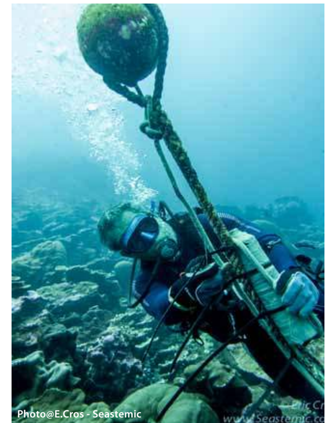
Figure 3-17. Remplacement d'un récepteur acoustique fixé sur un mouillage spécial prévu à cet effet. L'ancrage des trois récepteurs a été vérifié, le VR22 ayant fait l'objet d'un remplacement total.
